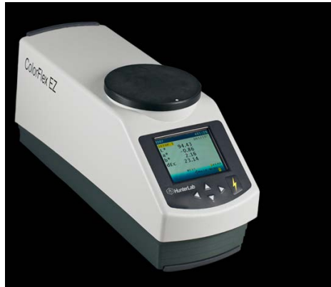
Figuras 33. Colorímetro Hunterlab Colorflex (Hunterlab, Reston, Virginia, U.S.A).
